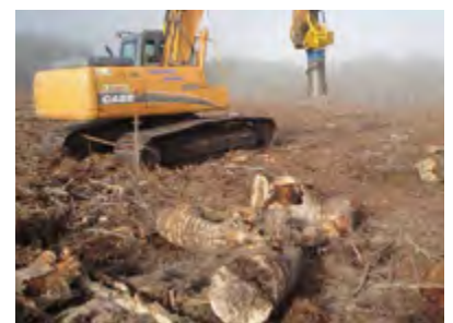
Figure 11 : Pelle équipée de l'outil d'extraction de cœurs de souches (Forêt Logistique Conseil)
